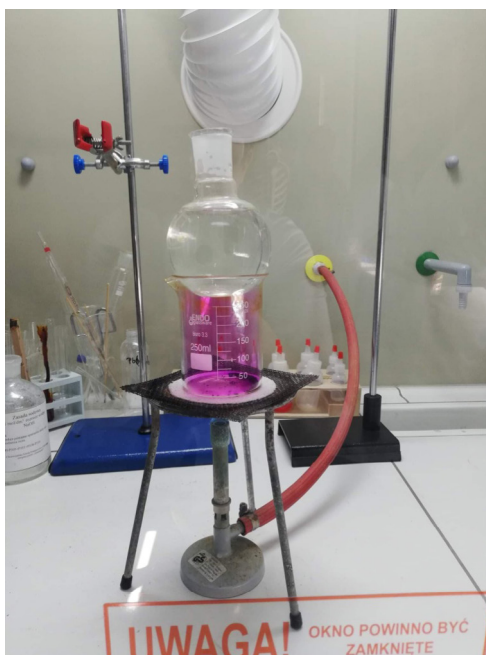
Zdjęcie 8. Sublimacja w zlewce zakrytej kolbą kulistą (fot. P. Kachel)
